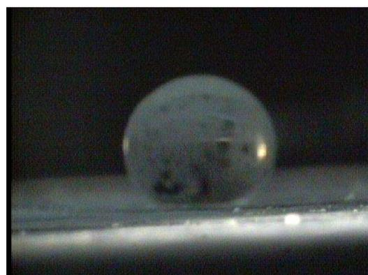
図 7 撥水处理された粉体上の水滴( $5.5 \mu\text{l}$ )
